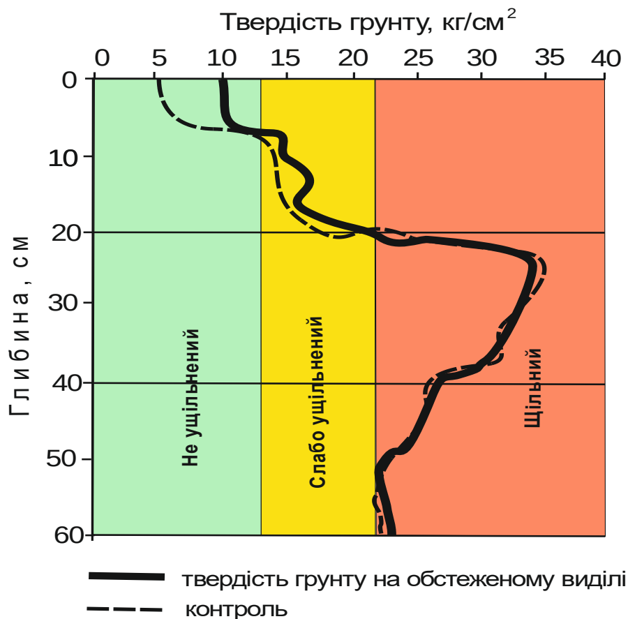
Рис. 11. Крива твердості ґрунту, після проведених рубок головного користування сосни звичайної (квартал 16 виділ 19 Олександрійського лісництва) у порівнянні з контролем
