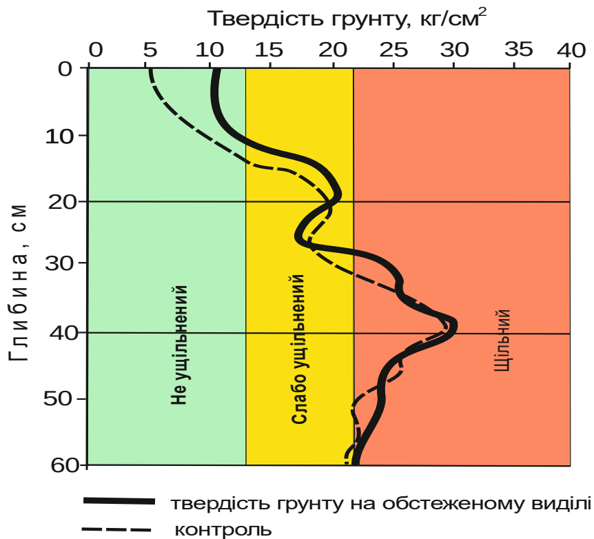
Рис. 3. Крива твердості ґрунту після проведених рубок головного користування сосни звичайної ( Pinus sylvestris L.) (квартал 14, виділ 5 Корчинського лісництва) у порівнянні з контролем
